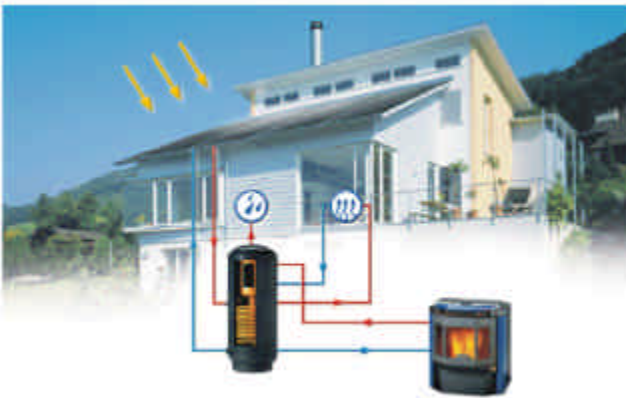
Riscaldamento 'solare e biomassa'
