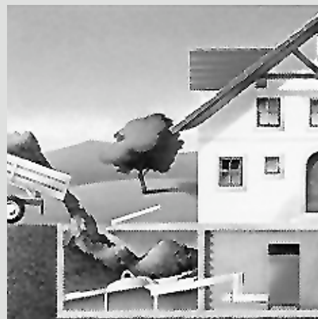
Impianto di riscaldamento domestico a cippato con silo interrato
